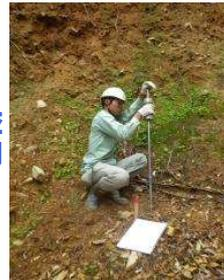
崩壊斜面での簡易貫入試験
